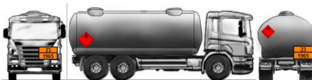
Obrázek 3 Příklad označení vozidla při přepravě nebezpečných věcí v cisterně (standardní ADR)
