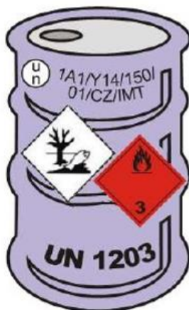
Obrázek 6 Příklad označení kusu (kusová přeprava včetně podlimitu, certifikovaný obal (zn. „UN“ v kruhu))
