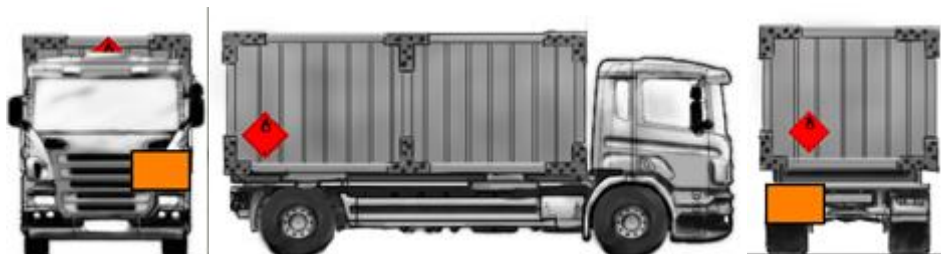
Obrázek 2 Příklad označení vozidla při přepravě nebezpečných věcí v kusech v kontajneru (standardní ADR)
